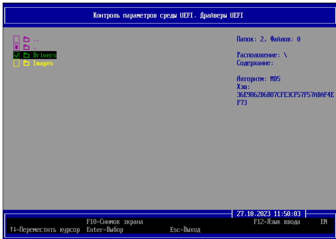
Рисунок 7.15 – Установленные на КЦ драйверы UEFI
